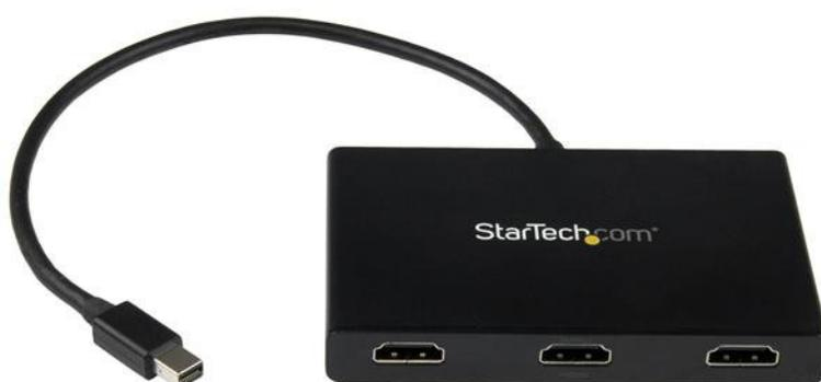
Ce hub MST vous permet de brancher trois moniteurs HDMI à votre ordinateur Mini DisplayPort. MST peut être utilisé sur n'importe quel appareil Windows® prenant en charge DisplayPort 1.2, comme des modèles Lenovo™ Think Pad® et Microsoft® Surface™. Lorsqu'il est connecté à des révisions précédentes de DisplayPort, comme DP 1.1, le hub MST tient lieu de répartiteur vidéo.
